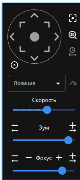
Для поворота камеры используются соответствующие кнопки или виртуальный джойстик, расположенный в центре, при зажатии которого и уводе в сторону производится управление камерой. Рядом с колесом управления находятся дополнительные кнопки:
