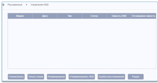
Прежде чем начать запись на носитель, необходимо нажать на кнопку «**Отформатировать HDD**». После форматирования устройства хранения запись на него начнётся автоматически.
