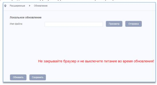
Для загрузки обновлений нужно нажать на кнопку «Просмотр» и выбрать необходимый файл. Чтобы установить выбранное обновление на регистратор, нужно нажать на кнопку «Отправка».
