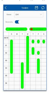
В строке «**Канал**» можно выбрать канал для настройки расписания. Настройка «**Включить**» позволяет включить/выключить работу расписания.
