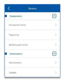
Во вкладке «Кодировать» можно настроить параметры кодирования записи каждого потока отдельно.
