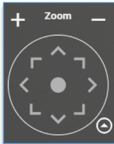
Кнопка раскрывает/скрывает настройки управления камерой. По умолчанию настройки открываются в упрощённом режиме, где отображаются только кнопки для поворота камеры и приближения/отдаления.
