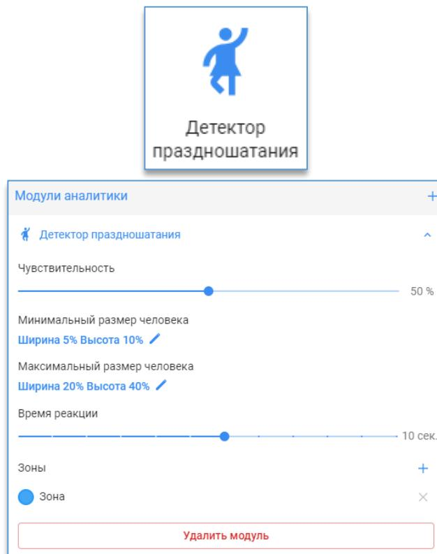
После добавления модуля «Детектор праздношатания» на изображении с заранее выбранной для канала камеры отобразится зона, которую можно редактировать, перетаскивая её с помощью мыши за точки на границах зоны.
