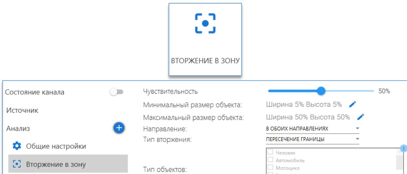
После добавления модуля «Вторжение в зону» на изображении с заранее выбранной для канала камеры отобразится зона, которую можно редактировать, перетаскивая её с помощью мыши за точки на границах зоны.
