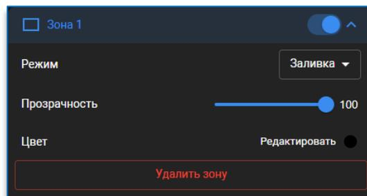
В настройках можно выбрать режимы «заливка» и «мозаика». В режиме заливки можно дополнительно настроить прозрачность и цвет заливки зоны, в режиме мозаики – размер блока (от 1 до 3).
