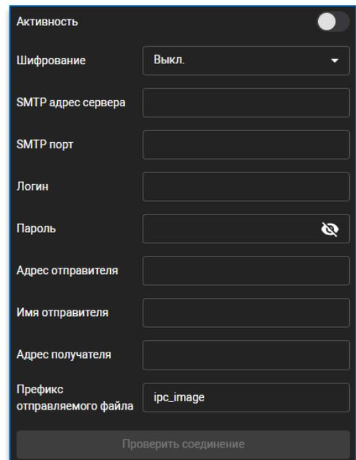
The screenshot shows a settings window for email notifications. It includes a toggle for 'Активность' (Activity), a dropdown for 'Шифрование' (Encryption) set to 'Выкл.' (Off), and input fields for 'SMTP адрес сервера', 'SMTP порт', 'Логин', 'Пароль', 'Адрес отправителя', 'Имя отправителя', 'Адрес получателя', and 'Префикс отправляемого файла' (set to 'ipc\_image'). A 'Проверить соединение' (Check connection) button is at the bottom.
