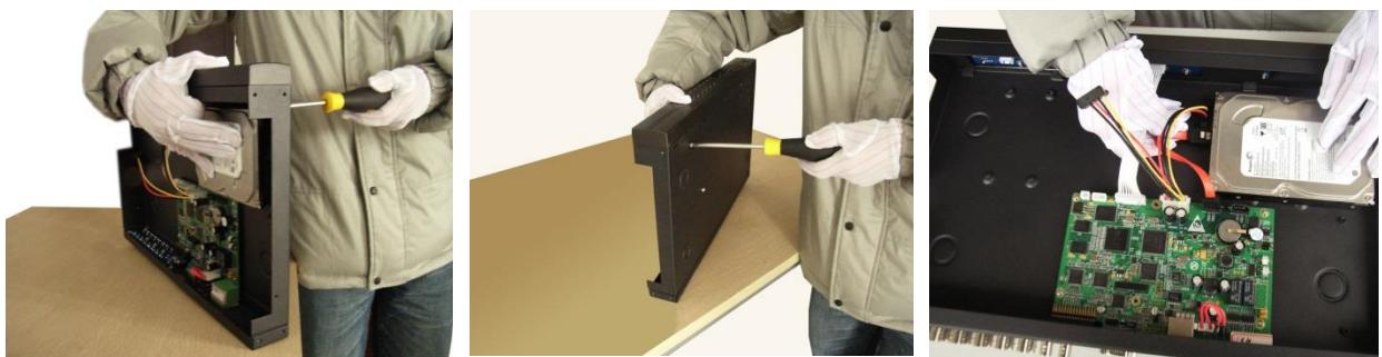
Совместите отверстия в креплении жесткого диска и в нижней части устройства **(внутри устройства!).**
