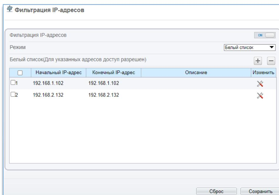
Для добавления IP-адреса в список необходимо нажать на кнопку +, после чего откроется окно, в котором нужно указать начальный и конечный IP-адреса, а также заполнить описание (необязательно). Для сохранения настроек следует нажать на кнопку «Ок» или «Отмена», если требуется отменить добавление адреса. Добавленные IP-адреса будут отображены в таблице.
