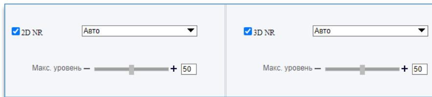
Для выбора той или иной функции нужно поставить отметку в чекбоксе напротив соответствующего наименования или сразу напротив обеих функций, если требуется их одновременное применение.
