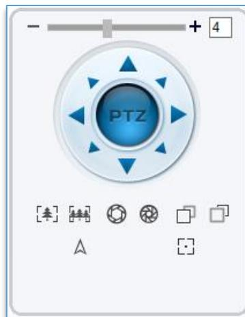
При нажатии левой кнопкой мыши на синие стрелки осуществляются повороты и наклоны камеры.
